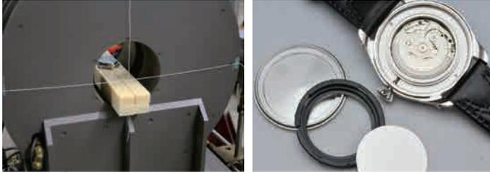
左図:プロガウスは、日本電気計器検定所で実際に10万A/mでの磁界曝露テストにかけられた。
